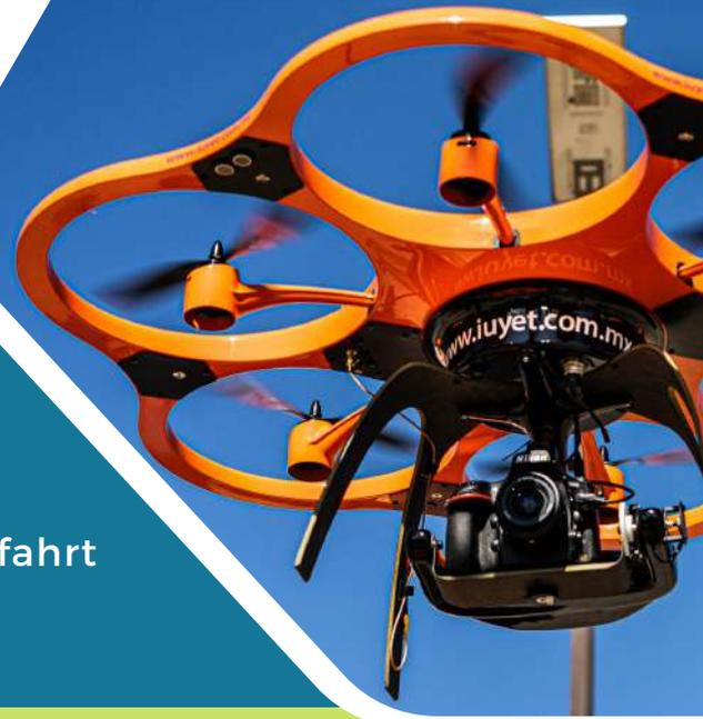
Der autonome Hexacopter ist mit einem hohen Maß an künstlicher Intelligenz ausgestattet und wird eingesetzt, um photogrammetrische Vermessungen und Inspektionen aus der Luft schnell, effektiv und sicher durchzuführen.
