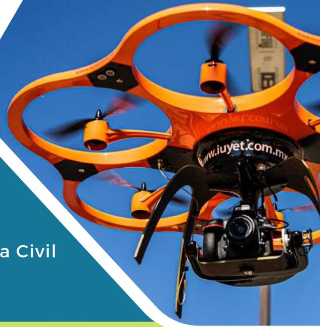
Hexacóptero autónomo equipado con un alto nivel de inteligencia artificial, se utiliza para realizar levantamientos fotogramétricos e inspecciones de obra desde el aire de manera rápida, efectiva y segura. Con la función "punto de interés" puede mantenerse suspendido en el aire en zonas específicas de difícil acceso. Su diseño y tecnología permiten que el UAV capture datos sobre coordenadas geo-espaciales.
