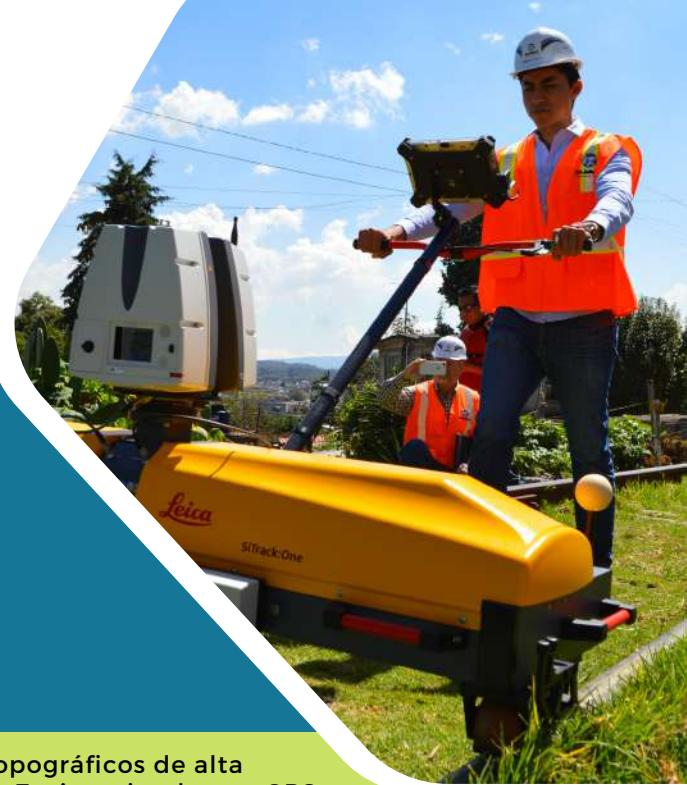
Sistema de posicionamiento independiente para levantamientos topográficos de alta resolución en tres dimensiones sobre cualquier vía de tren o metro. Está equipado con GPS, medidores láser (DMI) y Unidades de medición Inercial (DMU) que permiten su posicionamiento aún sin acceso a señal GPS.
