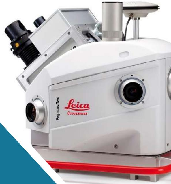
Mobile Ausrüstung zur Erfassung der Realität, d. h. zur Erfassung von Daten während der Bewegung entlang einer Flugbahn.
