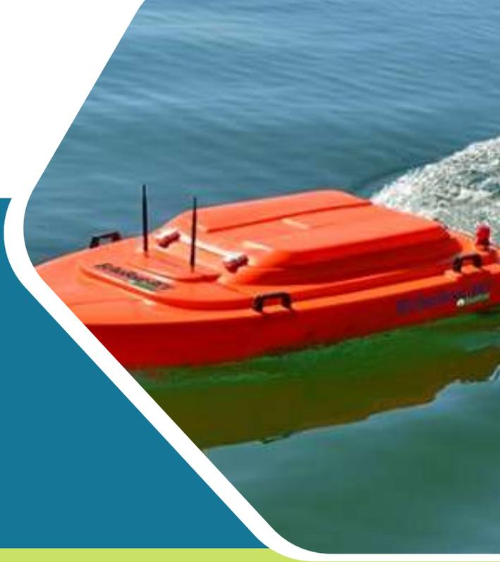
Das EchoBoat-RCV-System ist eine ferngesteuerte hydrographische Vermessungsplattform.
